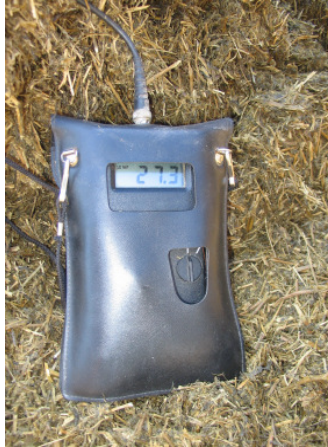
Temperaturmessung im Folienschlauch (Bohrloch)
